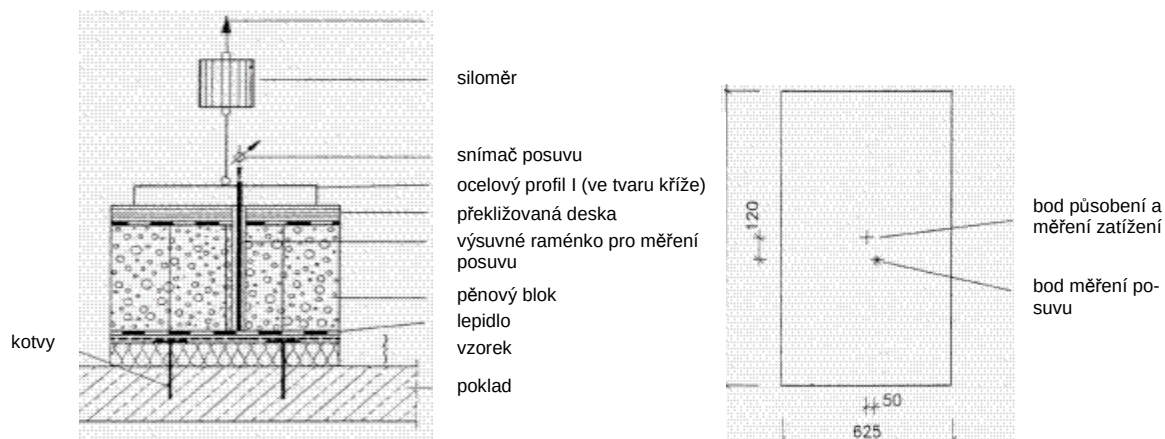
Obr. 9. Uspořádání zkoušky podle „metody pěnovým blokem“
