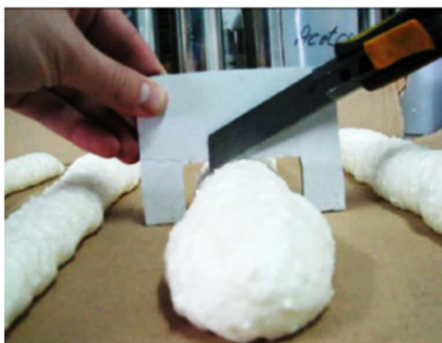
Obrázek F.3.3: Nalezení průměru 30 mm na válečku
