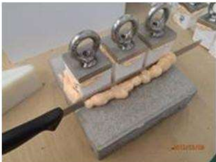
Obrázek F.4.7: Ořezávání přebytečné pěny
