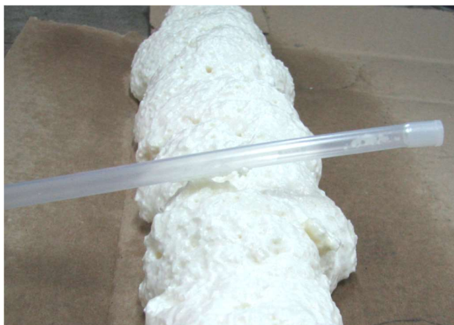
Obrázek F.3.2: Dotek válečku tyčinkou nebo trubičkou
